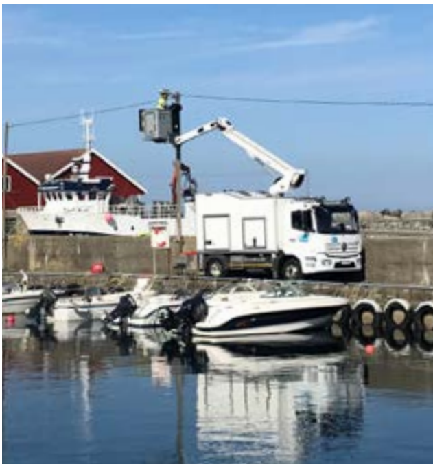
Haugaland Kraft har to plugin-hybrid-korgbiler, der liftene drives utslippsfritt og nærmest lydløst.
