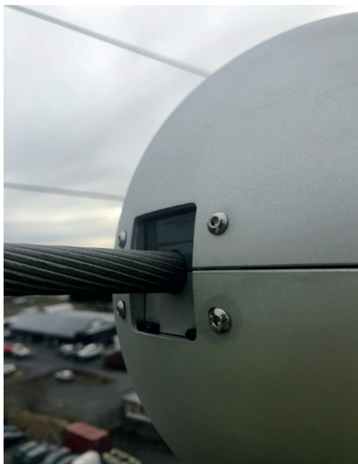
I 2019 testet nettselskapet sensorer plassert på høyspentlinje. Sensorene kan bidra til økt forsyningsikkerhet og effektivitet.
